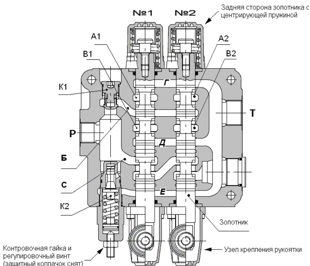
Рис. 6. Гидрораспределитель AMI R252
