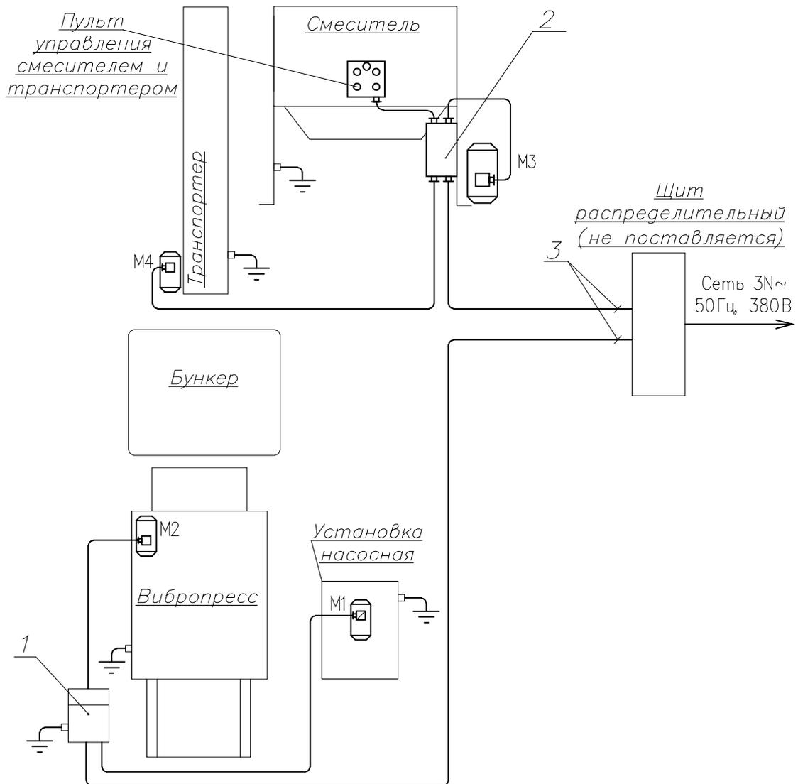
Рис. 16. Схема электрическая подключения.
