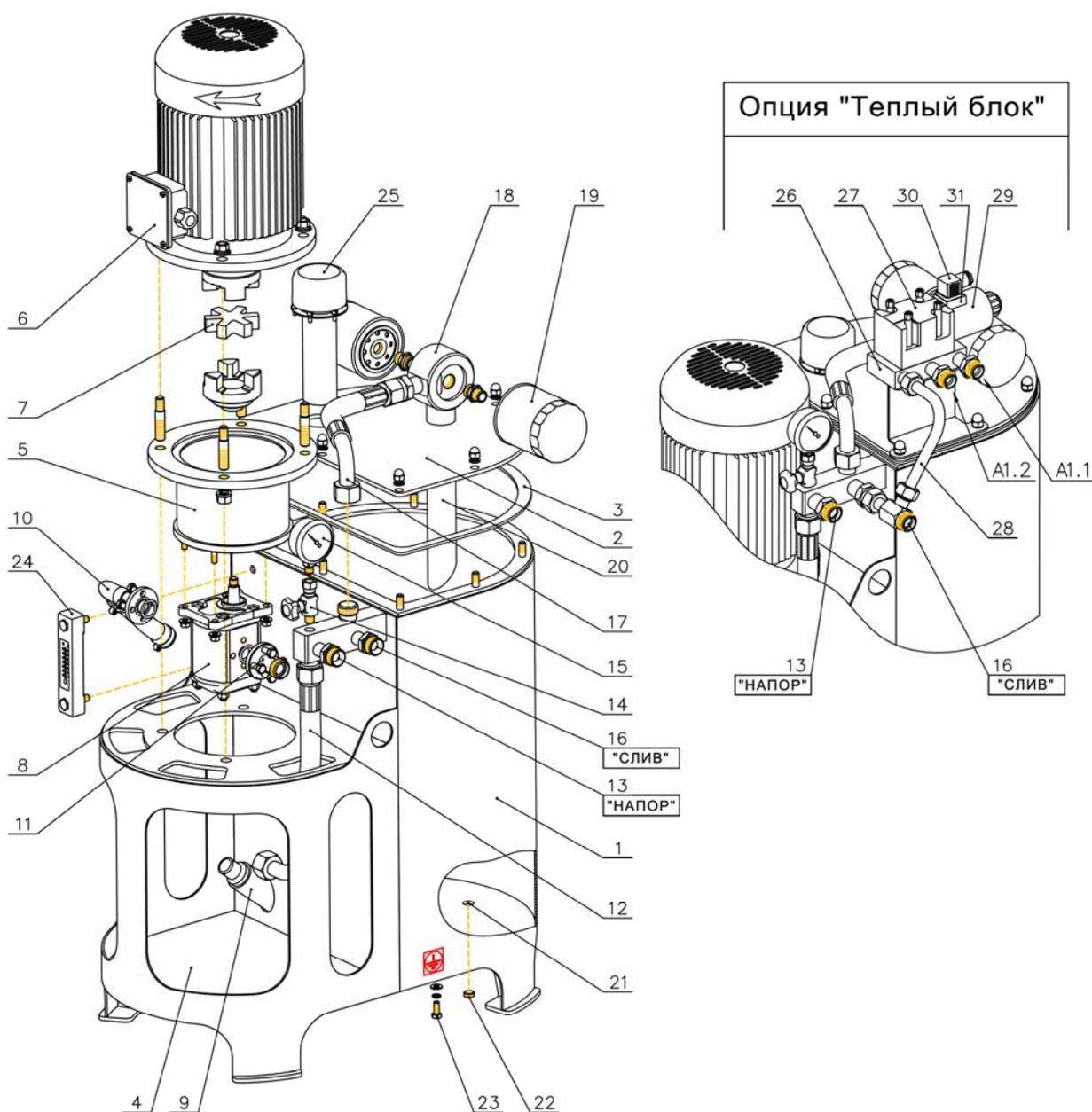
Рис. 5. Установка насосная.
