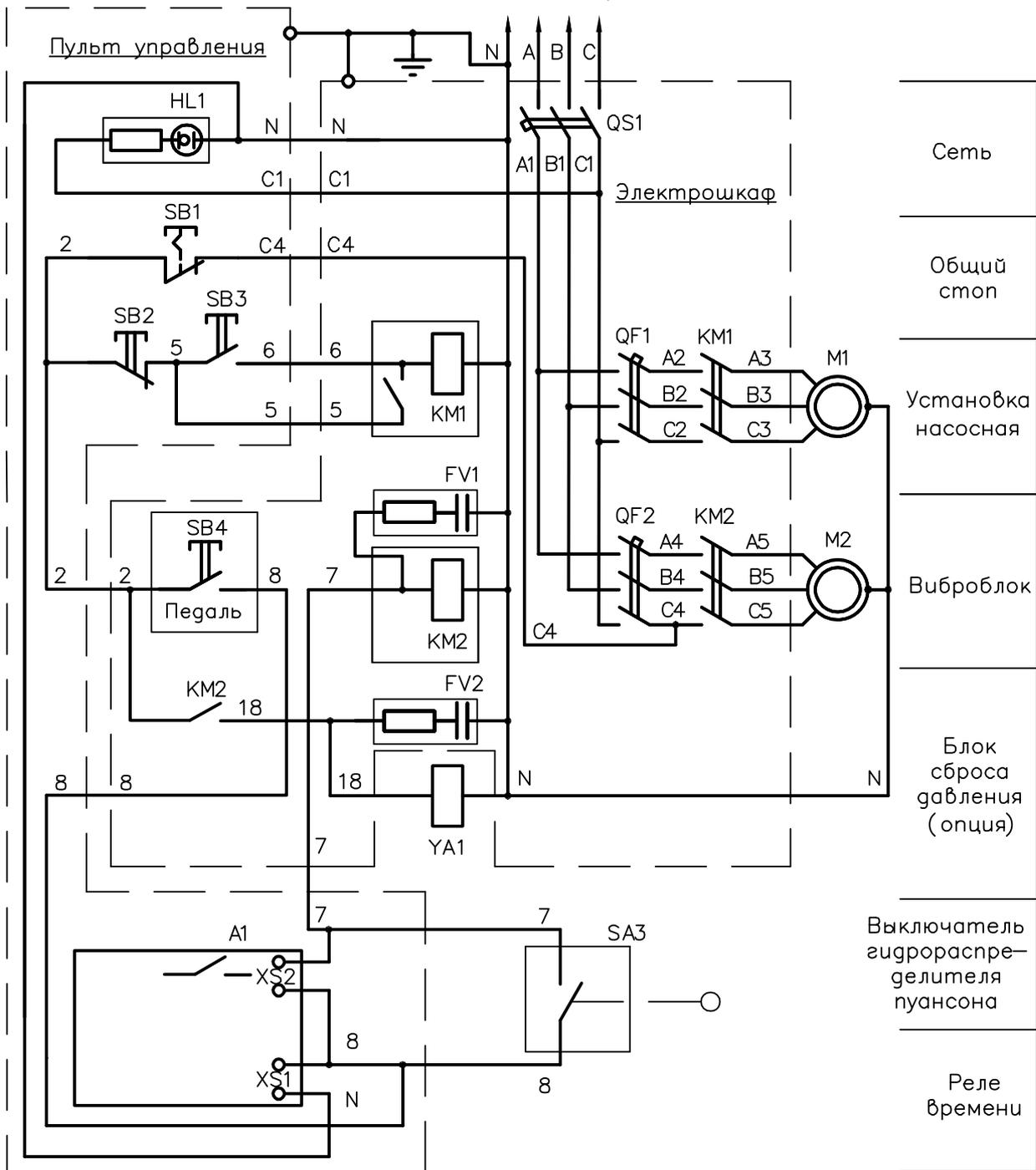
Рис. 14 .Схема электрическая принципиальная.
