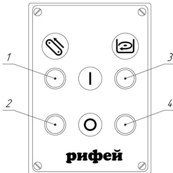
Рис. 10. Пульт управления смесителем и конвейером
