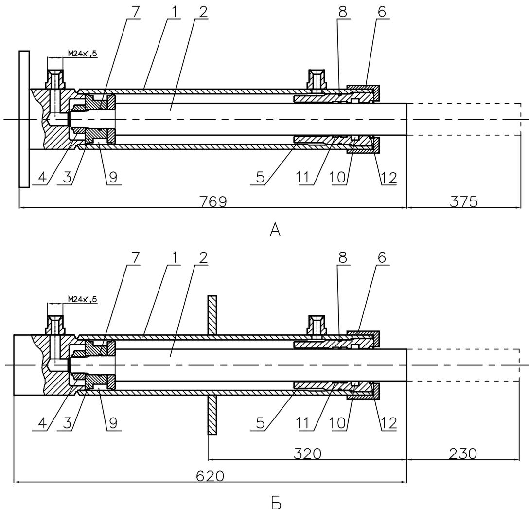
Рис. 7. Гидроцилиндры.
